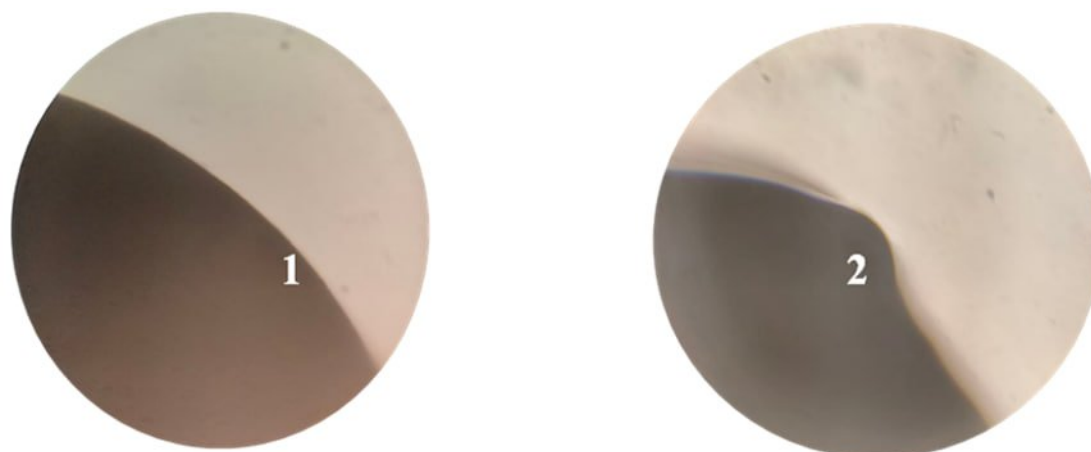
Рисунок 2. Поверхность бонда после использования традиционных микробрашей. Световая микроскопия, увелич. 100х (1 – ворсинка, 2 – слой бонда)
