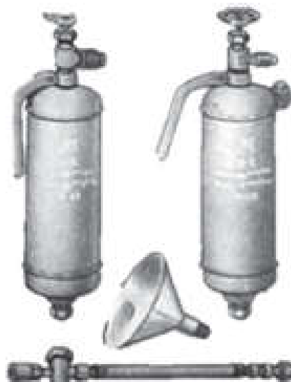
Рис. 12. Танковый дегазационный комплект
