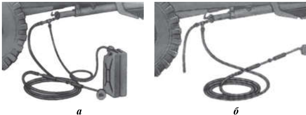
Рис. 13. ДК-4: а — газожидкостный метод; б — метод пылеотсасывания
