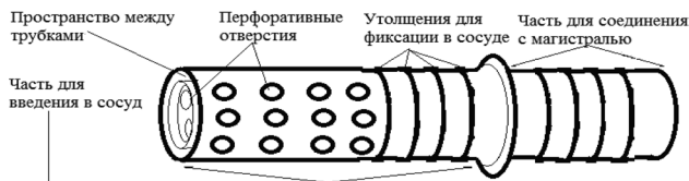
Рис. 2. Оригинальная канюля для перфузии органа при эксплантации
