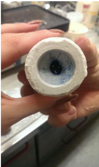
Рис. 15. Опока, освобожденная от подопочного конуса после затвердевания формовочной массы
