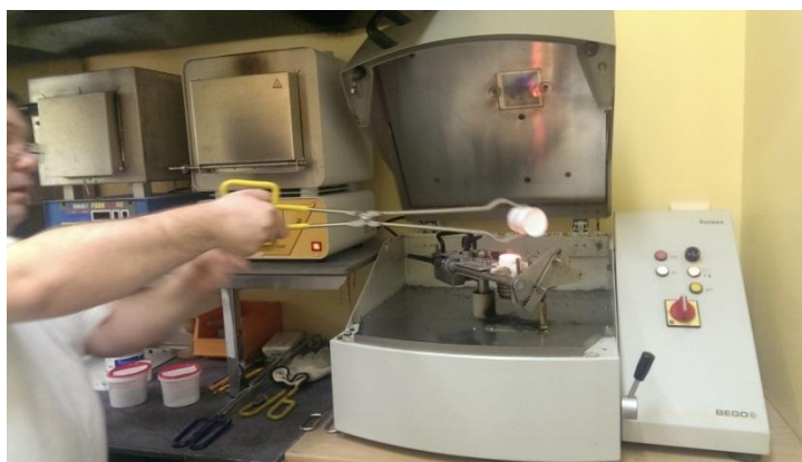
Рис. 18. Установка опоки в центрифугу литейной установки
