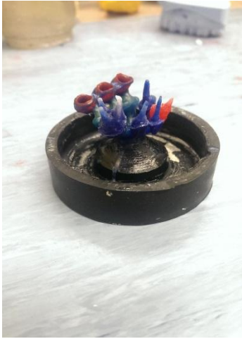
Рис. 12. Создание литниковой системы (елочка) на подопочном конусе
